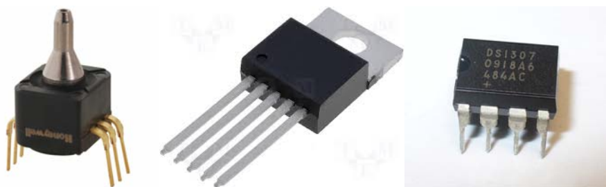
Фиг. 5. Общ вид на преобразувател 40PC006G2A, термометър TC74A2-5.0VAT и часовник DS1307
